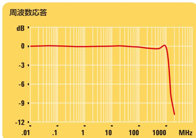
図3: 周波数応答はきわめてフラットであり、システム帯域幅は U1069A-001 および 003 の仕様である 1 GHz をかなり上回っています。
